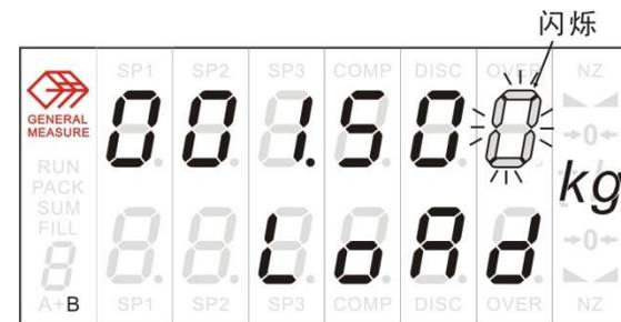
到 **B** 秤斗上，待显示稳定后（此时，仪表上排显示的即为标准砝码所对应的 **B** 秤传感器输出的毫伏数）如右图所示，进行重量输入状态，利用 **0~9** 数字键输入所加砝码的
