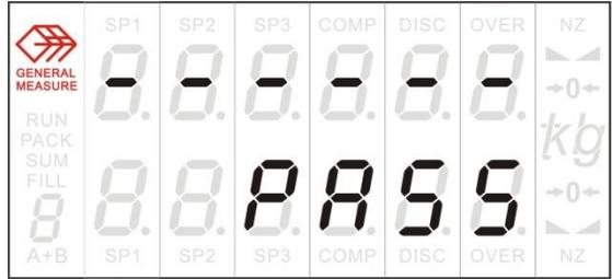
密码输入过程中，不管输入数据为何值，仪表都显示“8”。即：每输入一位数据，仪表主显示对应位由“-”变为“8”。如右图所示。
