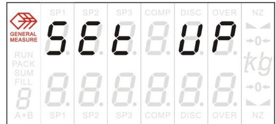
在整个设置过程中，上排显示为实际参数值，下排显示为参数代号 **FX.X**。
