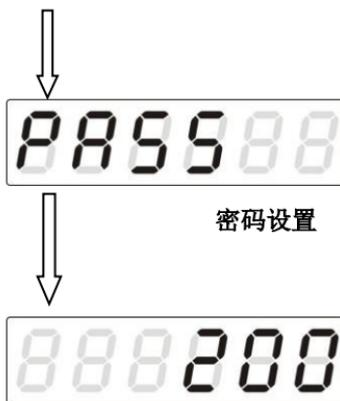
10. 参照第 5.4 章节操作流程完成密码设置后，返回正常状态。
