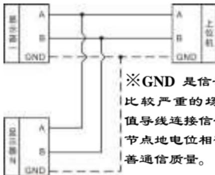
※GND 是信号地，在干扰比较严重的场合应用低阻值导线连接信号地，使各个节点地电位相等，可显著改善通信质量。
