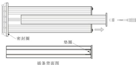
2.拧开显示器两侧插条螺丝，并拆下插条。
