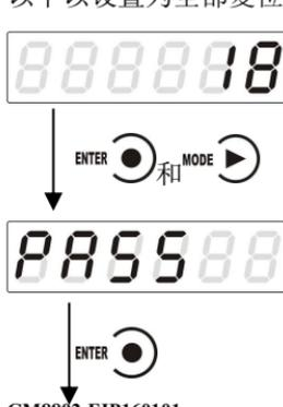
在正常工作状态下，按 **MODE** 1 次显示 **SET UP**，再同时按 **MODE** 和 **ENTER** 键，主显示显示 **'PASS'**。
