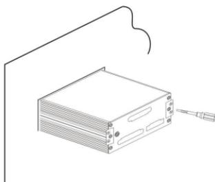
4.从显示器后面两侧插入插条并用螺丝固定。
