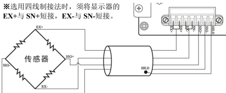
注意：1. 由于传感器输出信号是对电子噪声比较敏感的模拟信号，因此传感器接线应采用屏蔽电缆，并且与其它电缆分开铺设，尤其是要远离交流电源；
