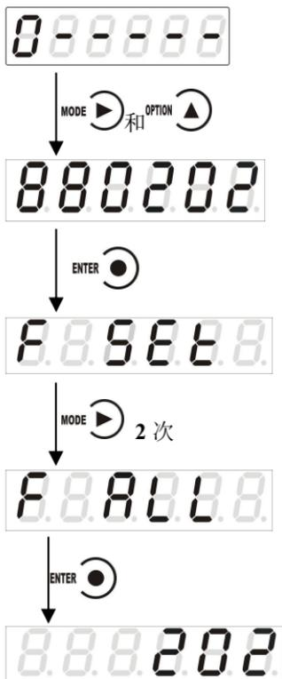
输入恢复出厂设置固定密码 **880202**。按 MODE 和 OPTION 进行值的设置，按 ENTER 密码保存进入工作参数复位界面界面。
