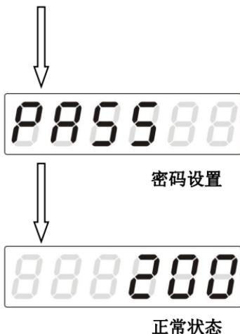
10. 参照第 6.1 章节操作流程完成密码设置后，返回正常状态。
