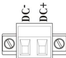
24V 电源正接 DC+端，24V 电源负接 DC-端。
