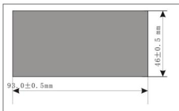
1.按照开孔尺寸在控制箱的合适位置开孔。
